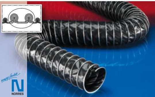
**Elektrisch leitfähiger Absaug- und Gebläseschlauch, TEFLON® <math>10^6 \Omega</math>, superleicht und stauchbar, hoch chemikalienbeständig, ableitfähig (bis +170 °C)**
