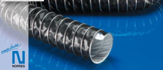
**Absaug- und Gebläseschlauch, Teflon®, doppellagig, superleicht und stauchbar, Ø bis 1.000 mm (bis 170 °C)**
