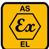
**Antistatisch bzw. elektrisch leitfähig Schläuche:** Gemäß neuer ATEX-Richtlinie und der deutschen BGR 132 sollen in explosionsgefährdeten Bereichen elektrisch leitfähige Schläuche verwendet werden. Derartige Produkte haben wir mit einem speziellen Symbol gekennzeichnet. Bitte beachten Sie die jeweilige Produktbeschreibung und den Technischen Anhang.
